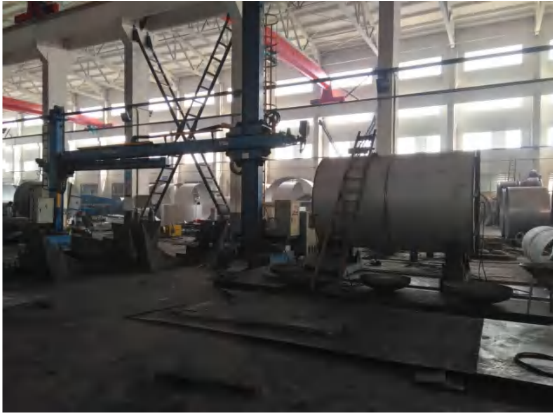
生产车间全自动焊接生产线
