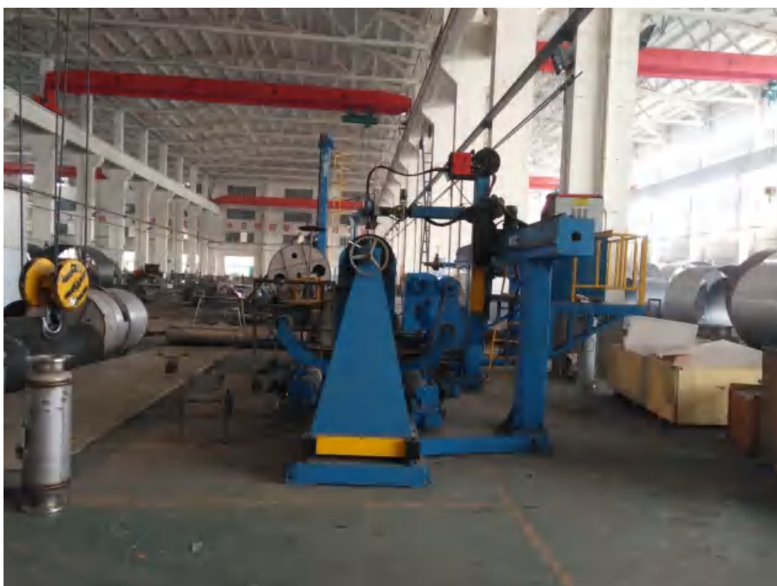
生产车间全自动焊接生产线
